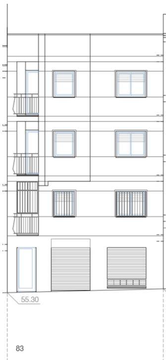
1.8.2.Planta y alzado edificio residencial entre medianeras, con estructura de muros de carga y viguetas
