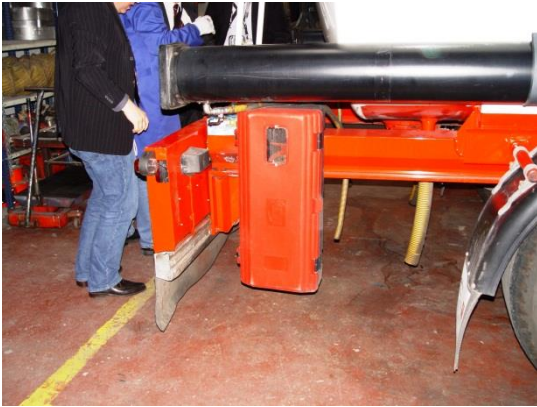
Imagen 3.10.4: Caja para extintor
