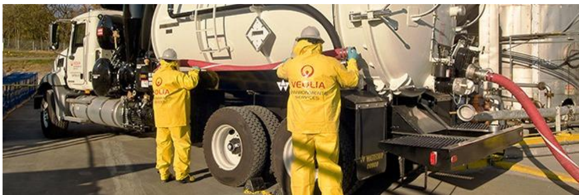
Imagen 3.6.2.4.2: Cisterna residuos opera al vacío
