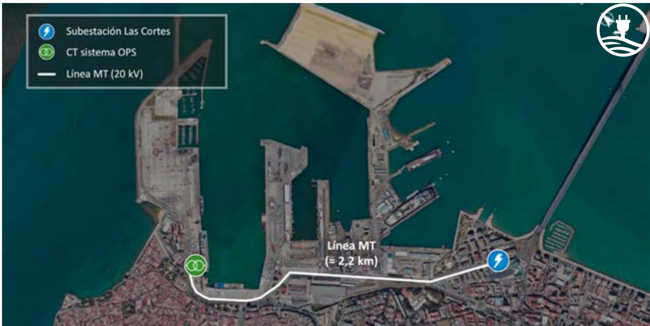
Acometida a la red eléctrica.
