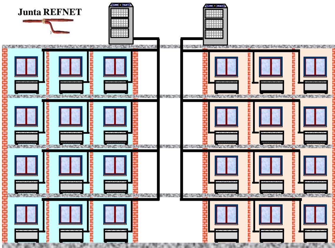
**Imagen 2.30:** Sistema de expansión directa de Caudal de Refrigerante Variable, las derivaciones se realizan con juntas “REFNET”, todas las unidades interiores conectadas a la misma unidad exterior deben funcionar en el mismo regimen: frio o calor; si se tienen zonas con necesidades opuestas se deben conectar a unidades exteriores diferentes.
