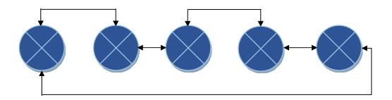
Como se observa en el esquema, cada uno de los nodos tiene una redundancia de comunicaciones que permite que ante un problema que suceda en la red general se pueda asegurar la transmisión por la misma.
