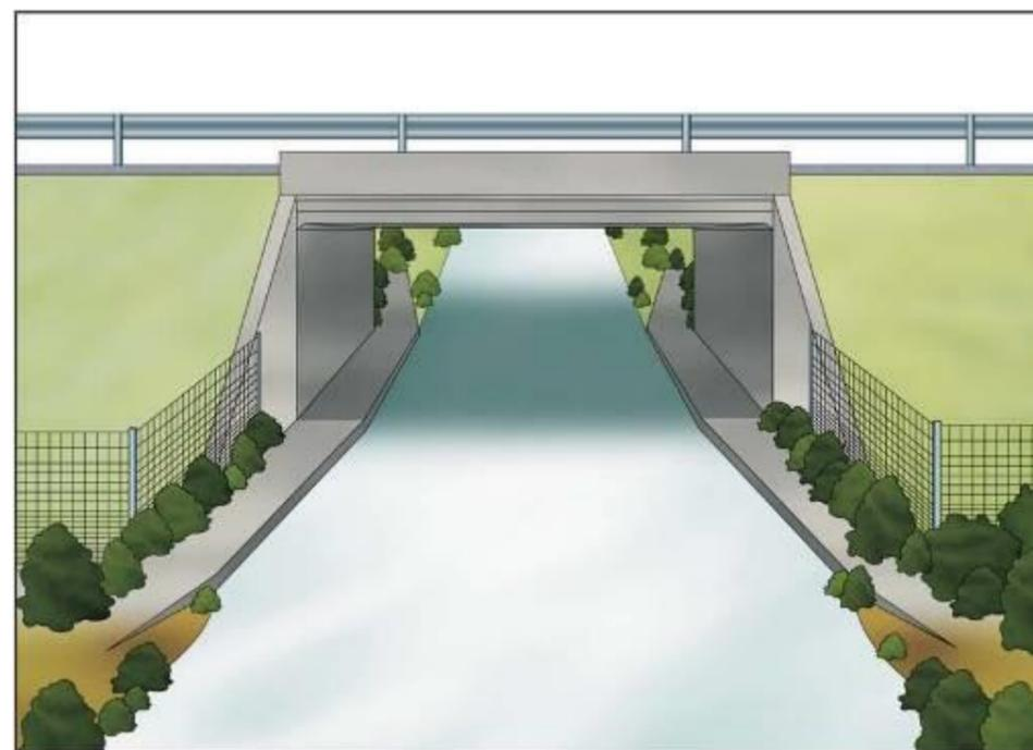
Esquema general de un drenaje adaptado para animales terrestres
