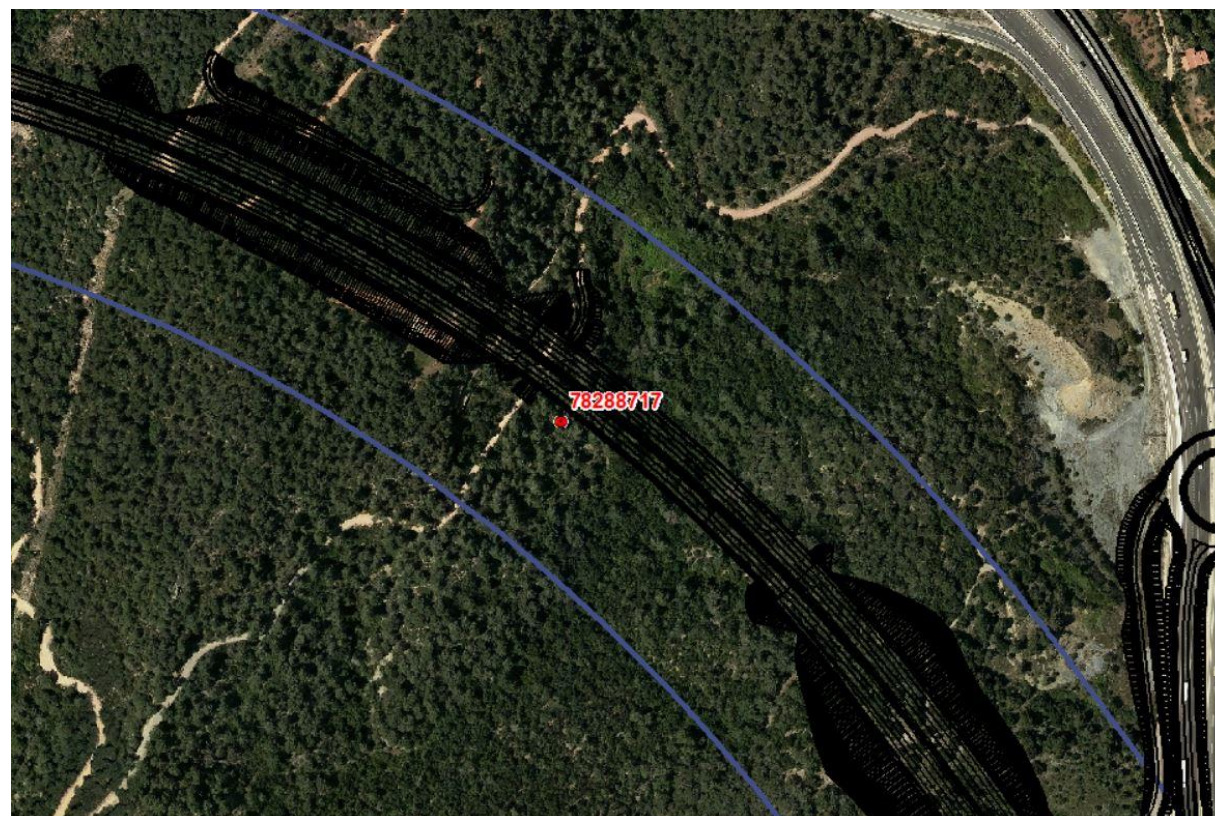
Figura 23d: Localización del manantial 78288717 que previsiblemente será destruido durante las obras de construcción del nuevo trazado (elaboración propia).
