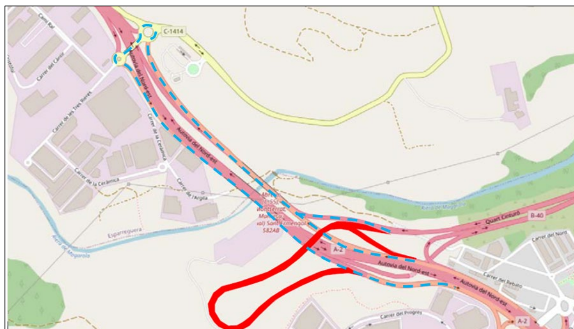
Fig. 38. Desvío de tráfico durante la construcción del PS 578,1 hasta el enlace 581 Odesa
