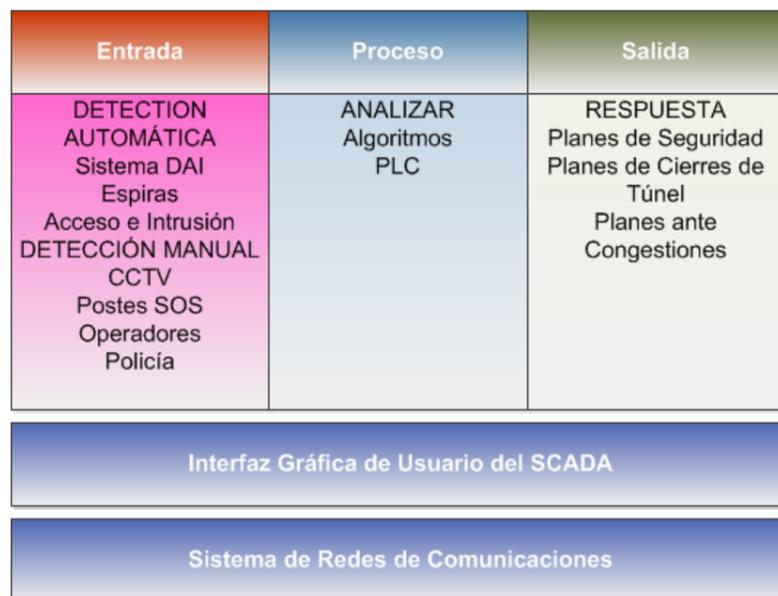
Ilustración 4.- Esquema de Proceso del Sistema de Control.
