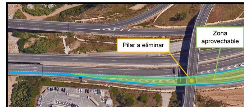
Ilustración 28: Identificación de la pila y zona aprovechable
