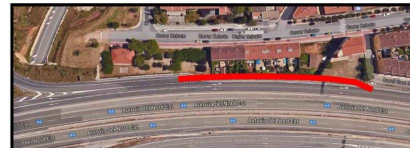
Ilustración 36: Propuesta de ampliación del carril de deceleración.
