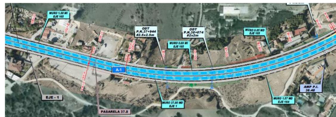
A partir del Enlace Variante de El Molar Sur, que se muestra a continuación, donde finaliza la rectificación del tronco y se cortan las vías complementarias, únicamente se contempla la ampliación del tronco de la carretera actual en un carril por sentido: hasta la altura del p.k. 42,0 en la margen izquierda, y hasta el 43,5 en la derecha, para conectar con la sección de la A1 que ya cuenta con tres carriles.
