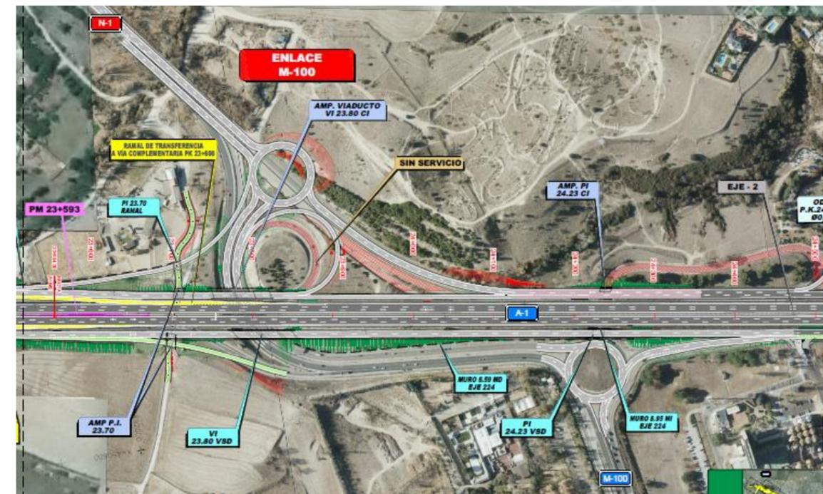
Comprende el subtramo la ejecución de 7 estructuras nuevas, la ampliación de 5 estructuras existentes, la construcción de 4 muros, y actuaciones de puesta a cero en 10 estructuras.
