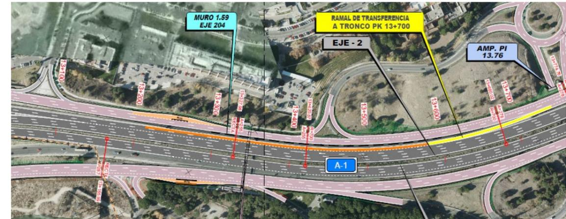
También se plantea entre el transfer de entrada en el tronco del 17+400 y el de salida del 18+600 la ampliación de un carril en la calzada de la margen derecha, por exigencias de tráfico.
