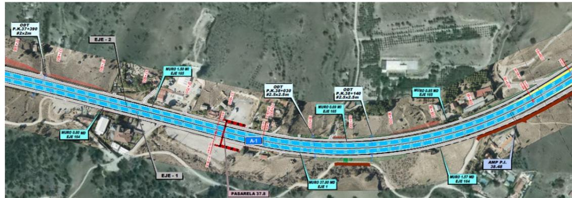
El enlace denominado de vías de servicio a la altura del p.k. 39+400 apenas si requiere el reajuste de sus ramales para la conexión con las vías complementarias en lugar de al tronco. Justo a su paso, en un tramo del orden de 600 m de longitud si se puede aprovechar el trazado actual de la A1.
