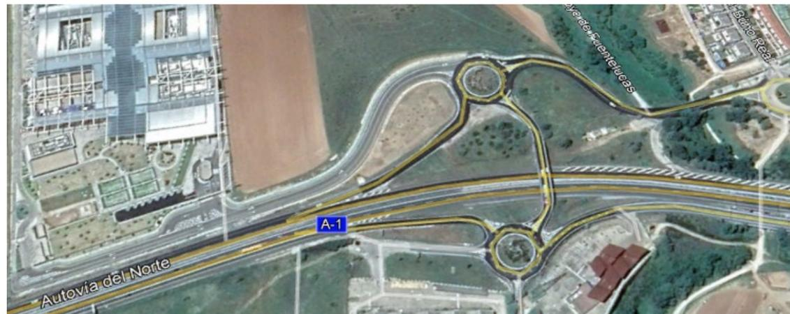
La solución proyectada se incluye a continuación, fuertemente condicionada por la construcción de los pasos superiores sobre la A1, y las instalaciones y líneas eléctricas pegadas a glorieta de la margen derecha.
