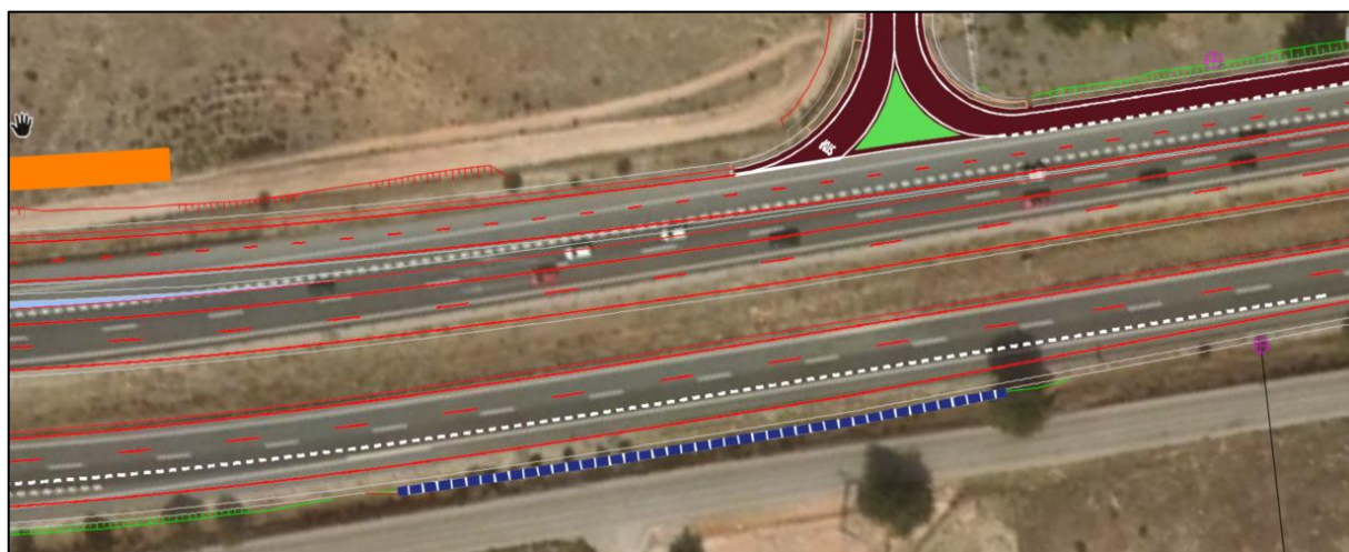
Vista de reducción de mediana para generar espacio en margen izquierdo. Se puede observar la nueva vía lateral en la parte superior.
