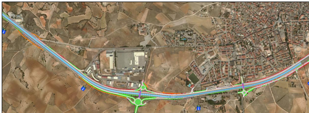
Vista de tramo completo de rectificación de trazado en tronco (eje 119), nueva vía lateral en margen izquierdo (eje 129) y adecuación de vía de servicio de margen derecho
