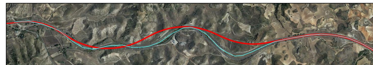
Vista de eje de nuevo trazado (en rojo) y eje de trazado actual (en azul).
