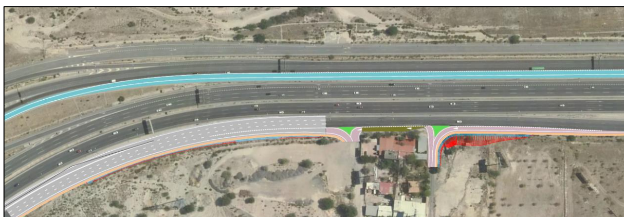
Cuña de salida del acceso del 12+700
