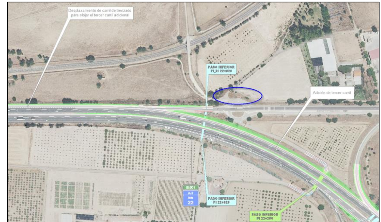
Imagen obtenida de los planos en planta con la Ortofoto (Hoja 13 de 58). Situación proyectada parada de autobuses 21_P.K. 22+000 MI. En glorieta Av. de Madrid
