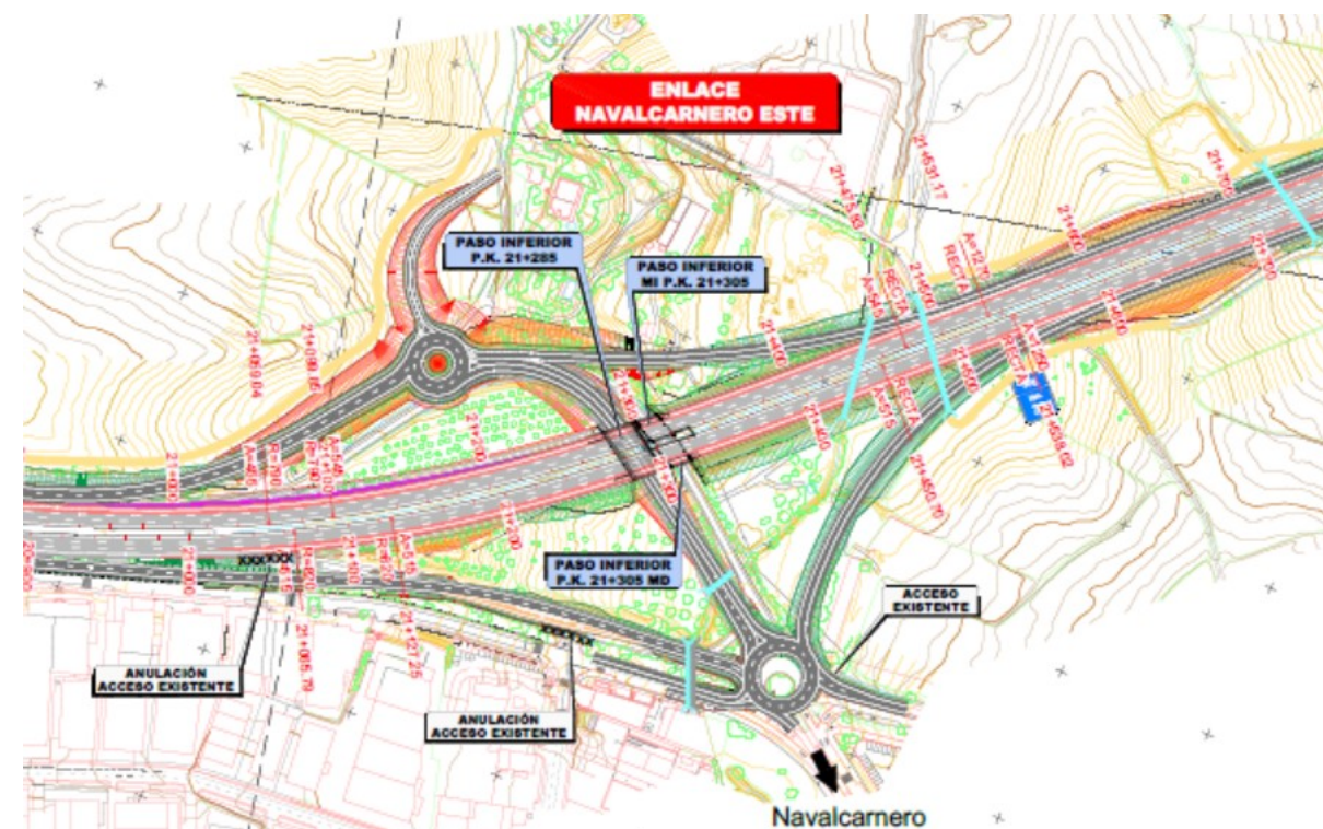
La vía complementaria de la margen derecha finaliza en la glorieta del enlace de Navalcarnero Este.
