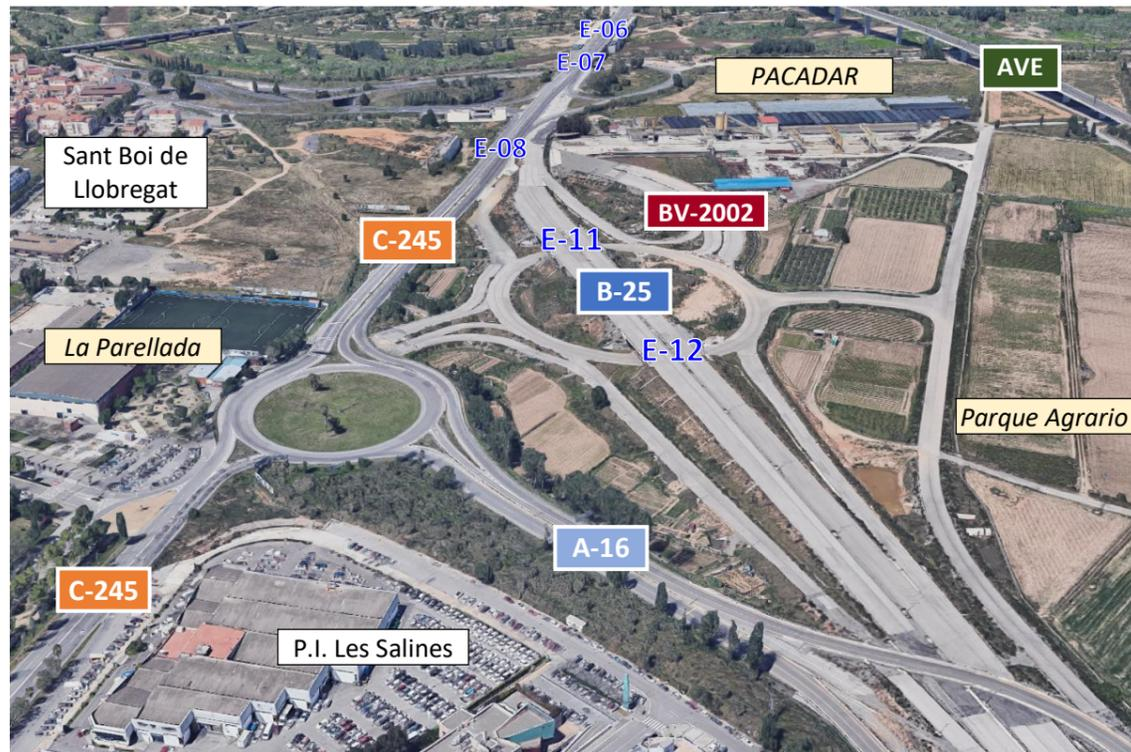
En este proyecto se diseña la terminación de este nudo sin modificaciones de relevancia respecto al trazado previsto anteriormente, de modo que se aprovechan en su mayoría las obras parcialmente ejecutadas. Solo cabe destacar la demolición del pequeño tramo ejecutado de la carretera BV-2002, puesto que la nueva configuración de la estructura E-08 requiere desmontar el vial en terraplén anteriormente ejecutado para llevar su rasante bajo la carretera B-25.
