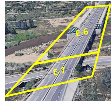
Así mismo, los nuevos condicionantes de proyecto hacen necesaria una elevación de su rasante hacia su estribo sur, lo que se resolverá mediante el recrecido de su pavimento y el refuerzo estructural del tablero original.
