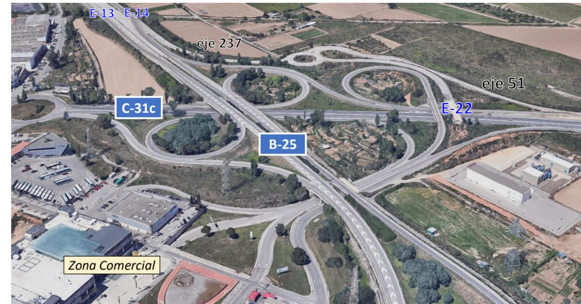
Con el diseño previsto en el proyecto de referencia, se habilita la posibilidad de conectar la salida de la zona comercial con la nueva vía de servicio (ejes 237, 51 y 201 respectivamente), y así acceder a la carretera B-25 en cualquiera de sus sentidos, a través de la glorieta elíptica del enlace de Sant Boi – Cornellá, o a la carretera B-20 sentido Cornellá de Llobregat, a través de un enlace parcial en diamante con pesas al noreste (enlace 55), fuera de la zona de actuación.
