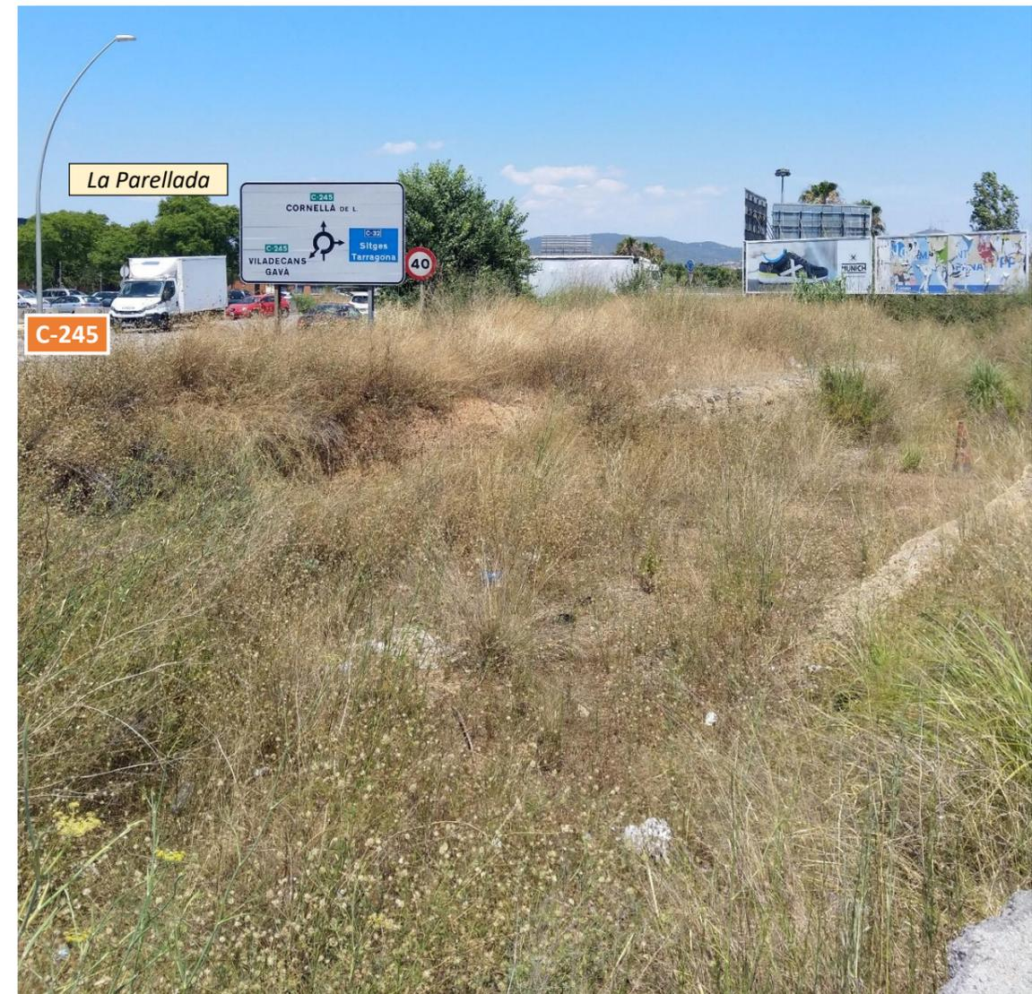
Tal como se puede observar en la anterior imagen, orientada desde la carretera C-245, dentro del P.I. Les Salines, hacia la glorieta existente en la zona de La Parellada, al norte, las obras de remodelación de esta intersección llegaron a iniciarse someramente con la demolición y vaciado de parte del área que ocuparía la nueva glorieta, dejando interrumpida la Calle Zaragoza.
