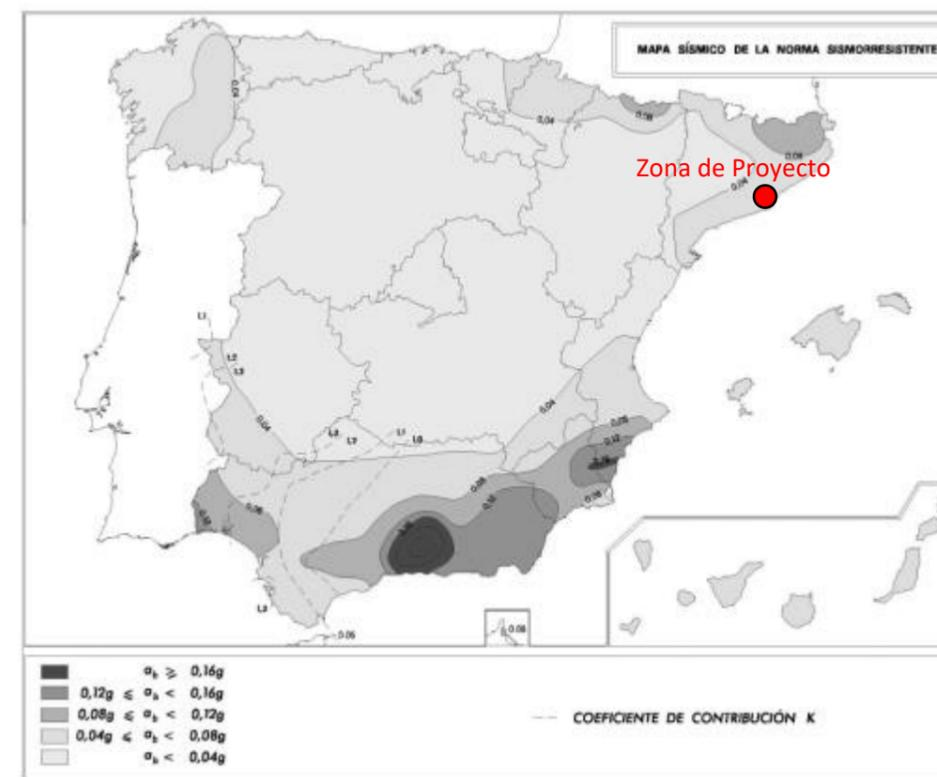
De acuerdo con los criterios de aplicación de la “Norma de Construcción Sismorresistente: puentes (NCSP-07)”, al no ser la aceleración sísmica horizontal básica inferior al valor  $0,04 \cdot g$ , es preceptiva su aplicación para este proyecto.
