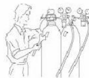
Antes de utilizar el equipo, asegurarse que todas las conexiones estén debidamente ajustadas.
