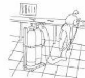
Las botellas de oxígeno y gas combustible han de estar en posición vertical y sujetadas con cadenas.
