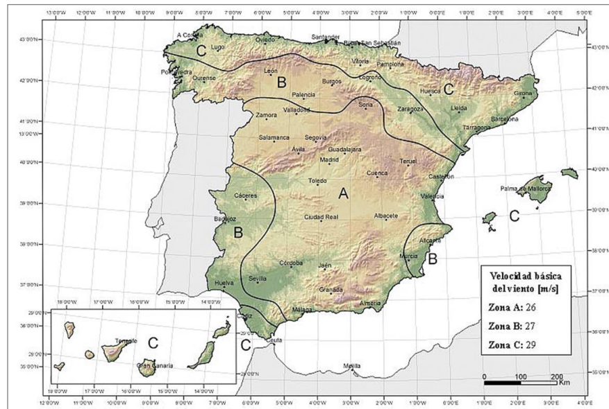
Figura 7. Mapa de isotacas para la obtención de la velocidad básica fundamental del viento v b,0 .
