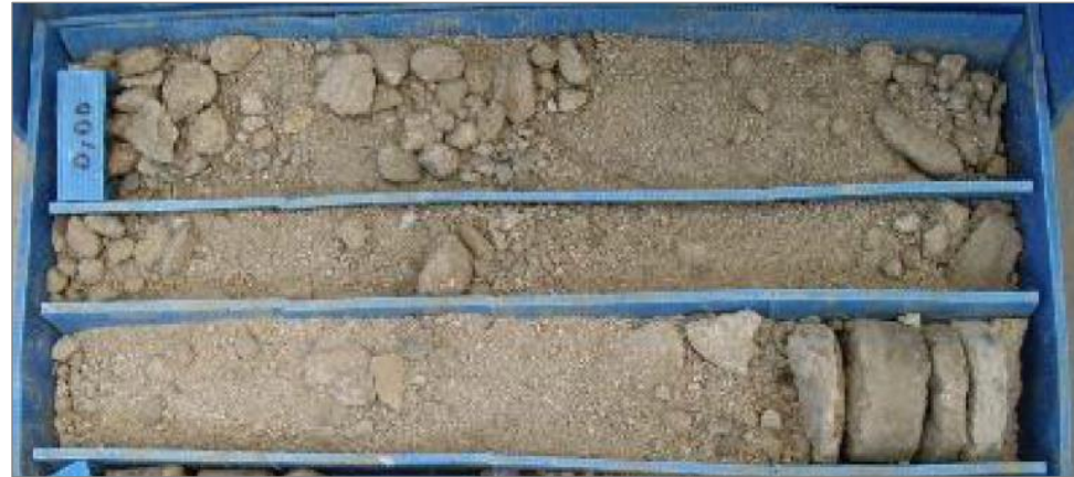
Figura 7. Detalle de la unidad litológica de Depósitos eluviales en el sondeo S-12.
