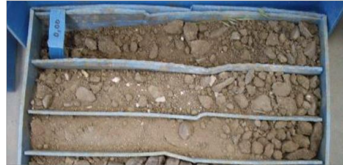
Figura 8. Detalle de la unidad litológica de Rellenos antrópicos de vertido en el sondeo S-15.
