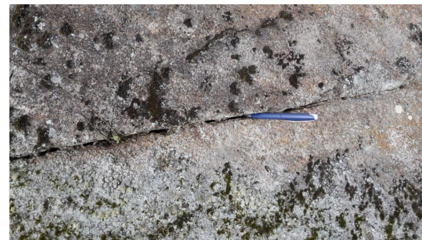
Foto 2. Discontinuidad sin relleno en afloramiento granítico en grado II PK 1+332
