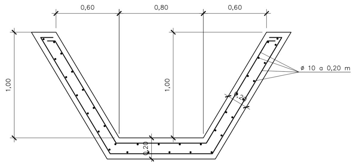
SECCIÓN TIPO. DETALLE DE ARMADO
