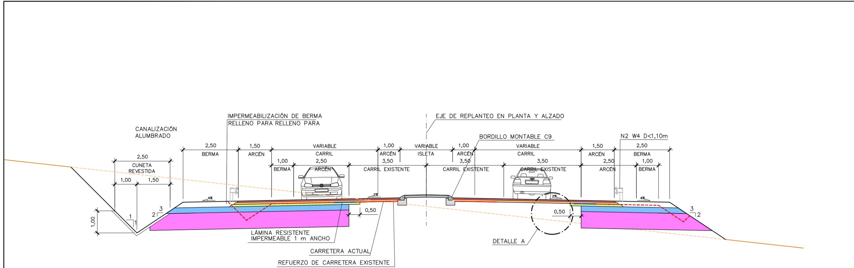
SECCIÓN TIPO DE AMPLIACIÓN DE PLATAFORMA DE N-5 EN EMBOCADURAS
