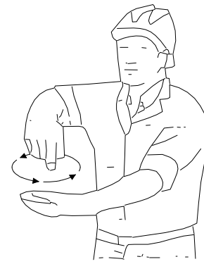
10 Bajar el aguilón o pluma y levantar la carga
