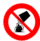
PROHIBIDO APAGAR CON AGUA
