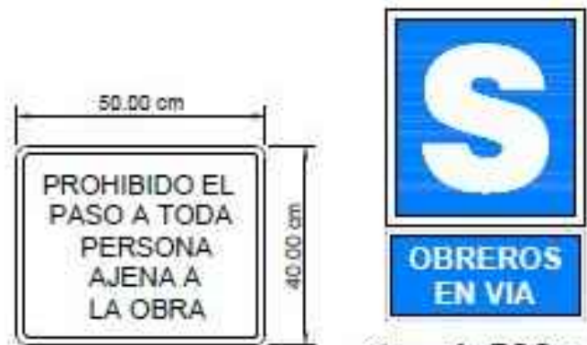
Carteles indicativos de riesgo
