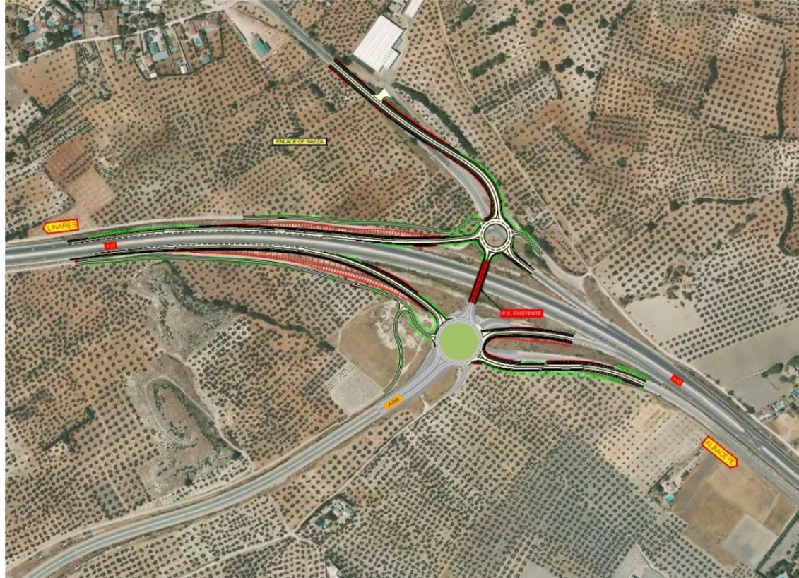
En la margen izquierda, se ha modificado la glorieta denominada "Glorieta Norte", ampliando su diámetro exterior a 56 m (frente a los 40m. actuales). Además, se ha incorporado el ramal de entrada en la A-32 "Ramal 4" en sentido Linares. Esta remodelación implica la adaptación del ramal de salida de la A-32 "Ramal 3" procedente de Albacete a la nueva glorieta y la reordenación y desplazamiento hacia el norte de las conexiones de la N-322A y los caminos agrícolas 1 y 2 con la mencionada glorieta.
