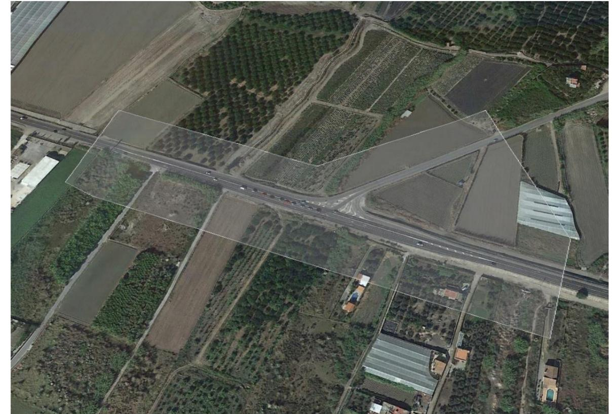
Esta superficie ha sido tomada directamente en campo por medios fotogramétricos, con ayuda de un DRON, para la toma de fotografía aérea, y de un GPS Trimble modelo 5800, para el apoyo del vuelo, partiendo de una base con coordenadas UTM conocidas, dado que la mayor parte de la cartografía existente se encuentra referenciada a este sistema de modo que si fuera necesario se facilitaría cualquier tipo de solape con ésta.
