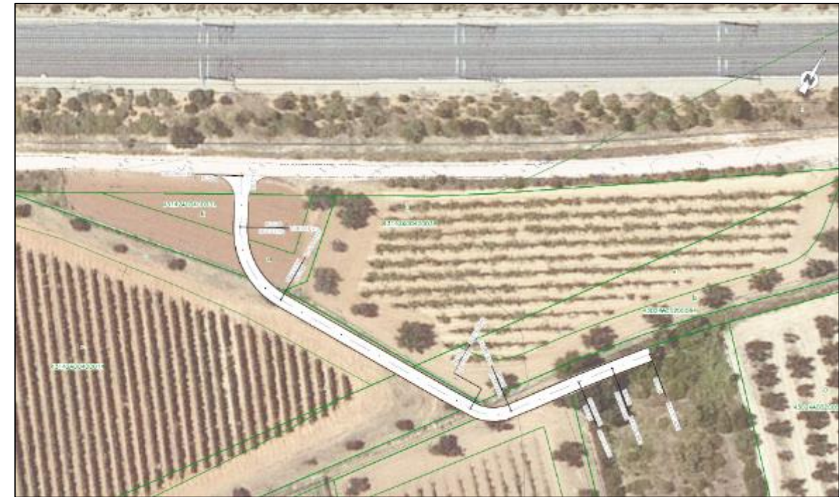
Planta del nuevo camino de acceso solapada con la distribución parcelaria. El origen se sitúa en el vial de servicio de la LAV
