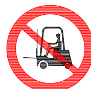
PROHIBIDO EL PASO A CARRETILLA
