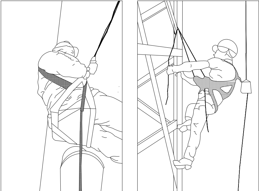
ANCLAJES CINTURON DE SEGURIDAD (Seguro automáticos anticaídas)
