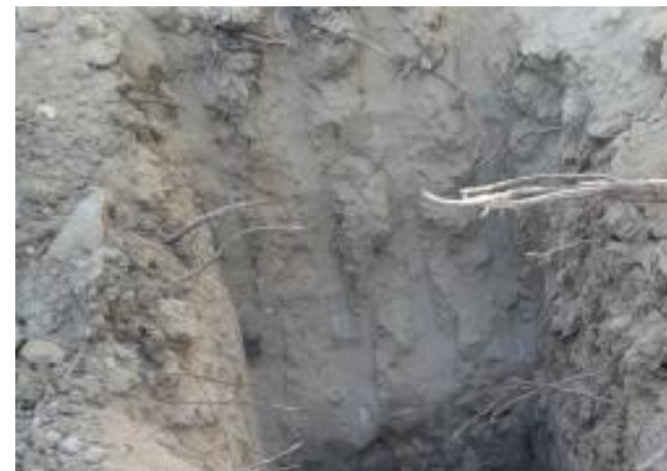
Aspecto de los materiales de Rellenos antrópicos en la calicata C1.
