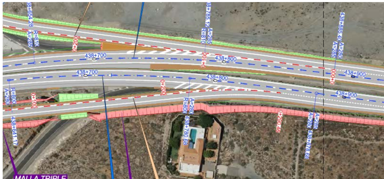
Ilustración 12: Punto de finalización ampliación en calzada sur. Fuente: Elaboración propia
