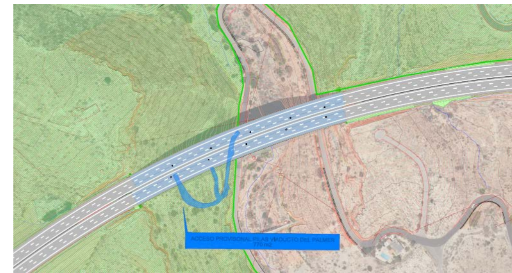
Ilustración 17: Afección al ZEC por los caminos de obra de acceso a las zapatas del viaducto de El Palmer. Fuente: Elaboración propia
