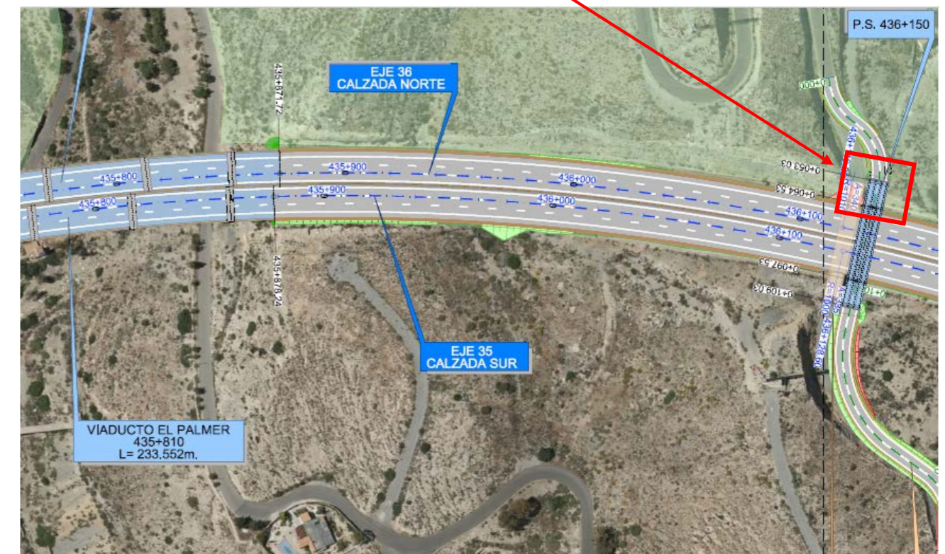
Ilustración 11: Paso superior en el P.K. 436+150. Fuente: Elaboración propia
