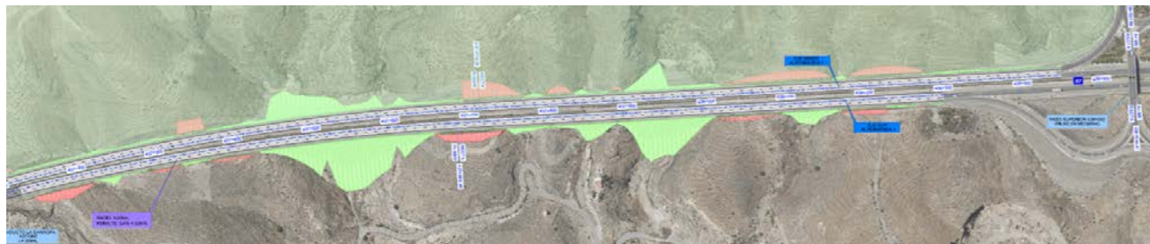
Ilustración 19: Movimiento de tierras en Alternativa 1. Fuente: Elaboración propia
