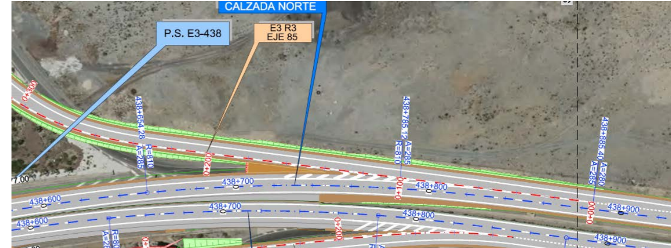
Ilustración 13: Punto de inicio ampliación en calzada norte. Fuente: Elaboración propia
