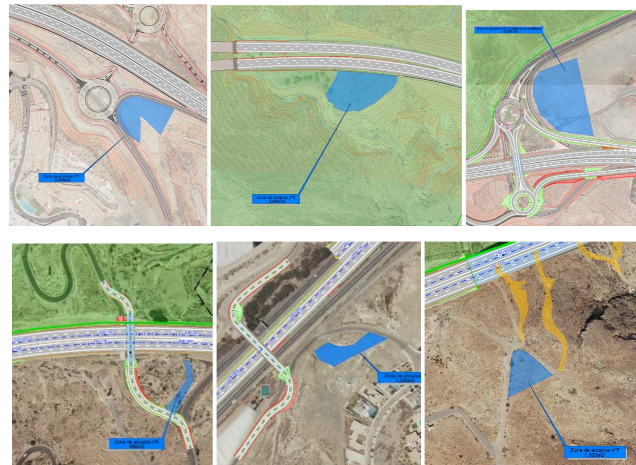
Ilustración 93: Zonas de acopio propuestas
