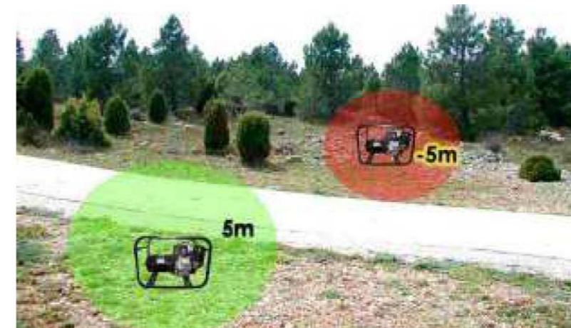
Ilustración 131: Emplazamiento de herramientas de obra. Fuente: Pliego General de normas de seguridad en prevención de incendios forestales en la ejecución de obras y trabajos realizados en terreno forestal o inmediaciones. Generalitat Valenciana
