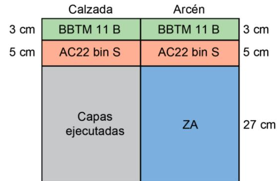
Para el ramal de conexión de la Autovía A-21 con la nacional N-240, se propone, como sección estructural del firme la **Sección 231**, de la Norma 6.1.- IC:
