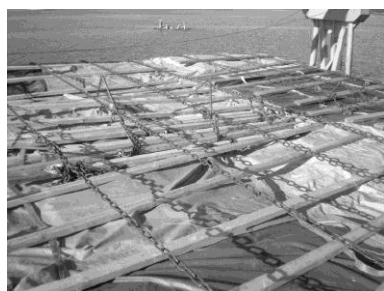
Trincas de cadena
