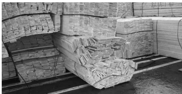
Figura 6.2: Ejemplo de rigidez insuficiente
