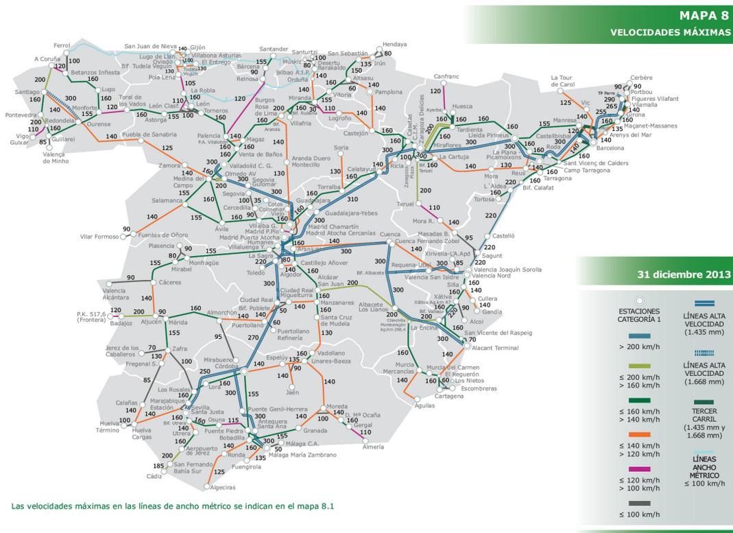
Figura 12. Velocidades máximas en la RFIG (Fuente: ADIF).
