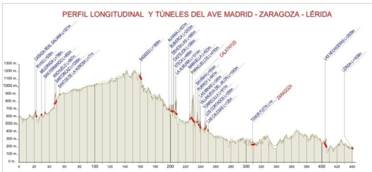
**Figura A5.1.** Tramo de Madrid hasta Lérida, nueva vía AVE, con 24 túneles construidos, sin contar los dos falsos túneles de Zaragoza y Lérida.
