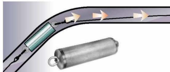
Al mismo tiempo que se comprueba el conducto con el mandril se deja instalada una cuerda guía de 5 mm. de diámetro, de nailon y con la suficiente flexibilidad y resistencia para facilitar posteriormente el tendido del cable.
