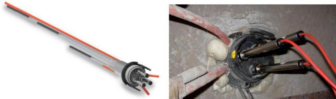
Figura 46. Extensómetros de varillas con tres niveles de anclaje
