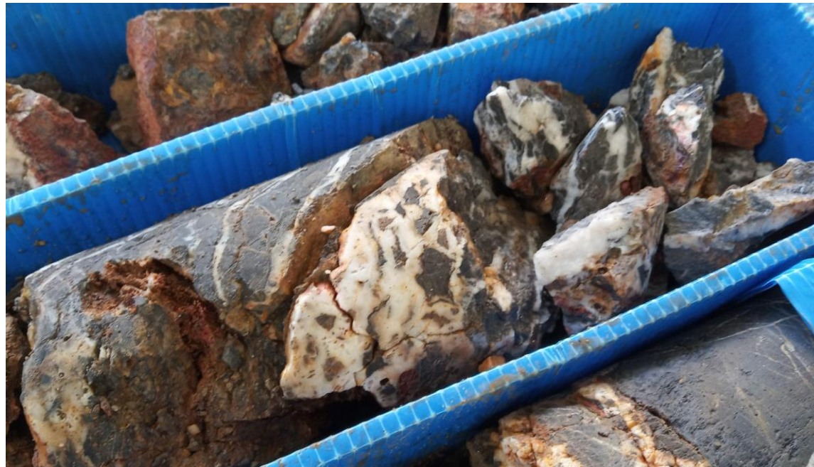
Fotografía 3. Detalle del aspecto oqueroso y brechoide en el testigo del sondeo S-01
