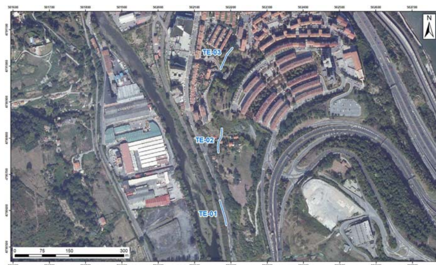
Figura 3. Plano de situación de los perfiles de investigación TE realizados (ETRS89 – 30N)
