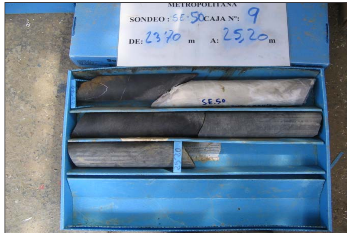
CAJA-09. Profundidad de 23.70 m a 25.20 m (Fín de Sondeo)
