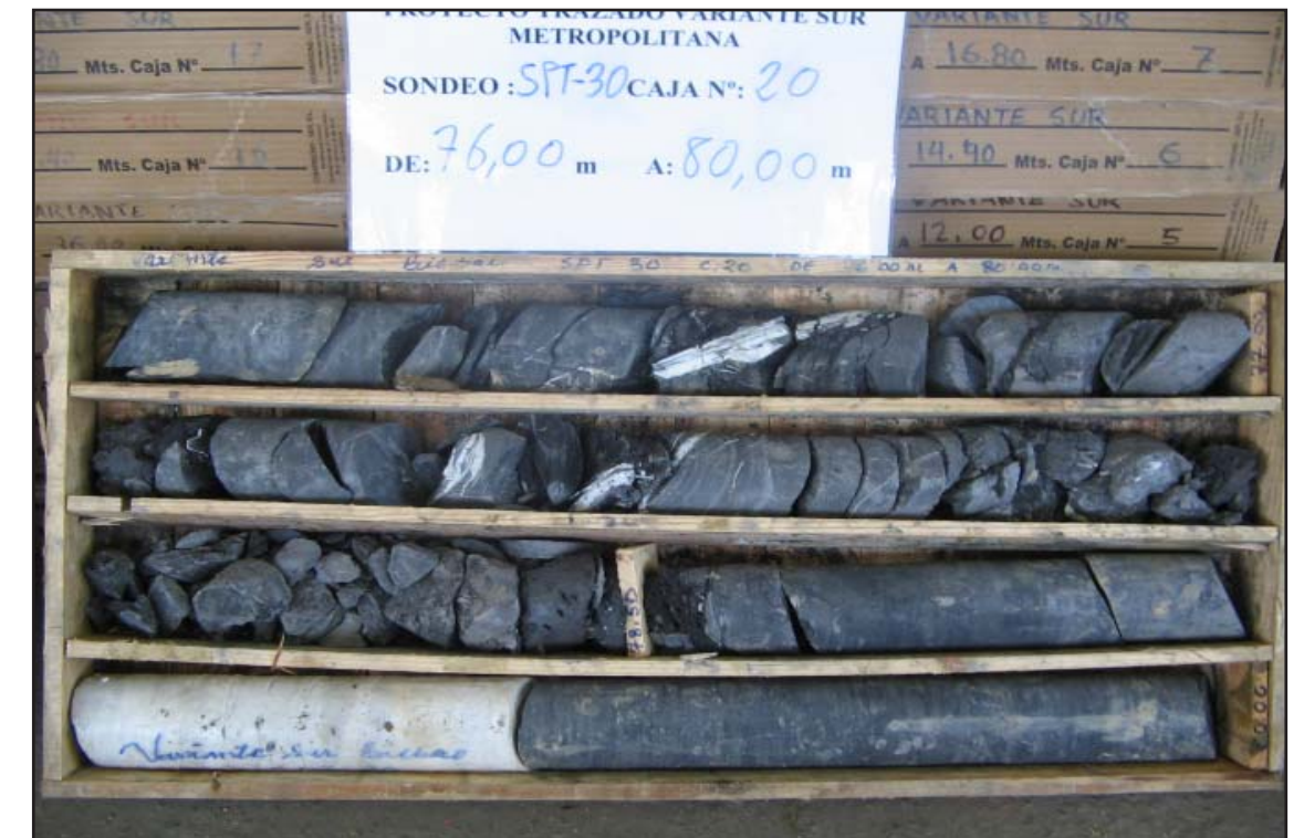
CAJA-20. Profundidad de 76.00 m a 80.00 m (Fín de Sondeo)
