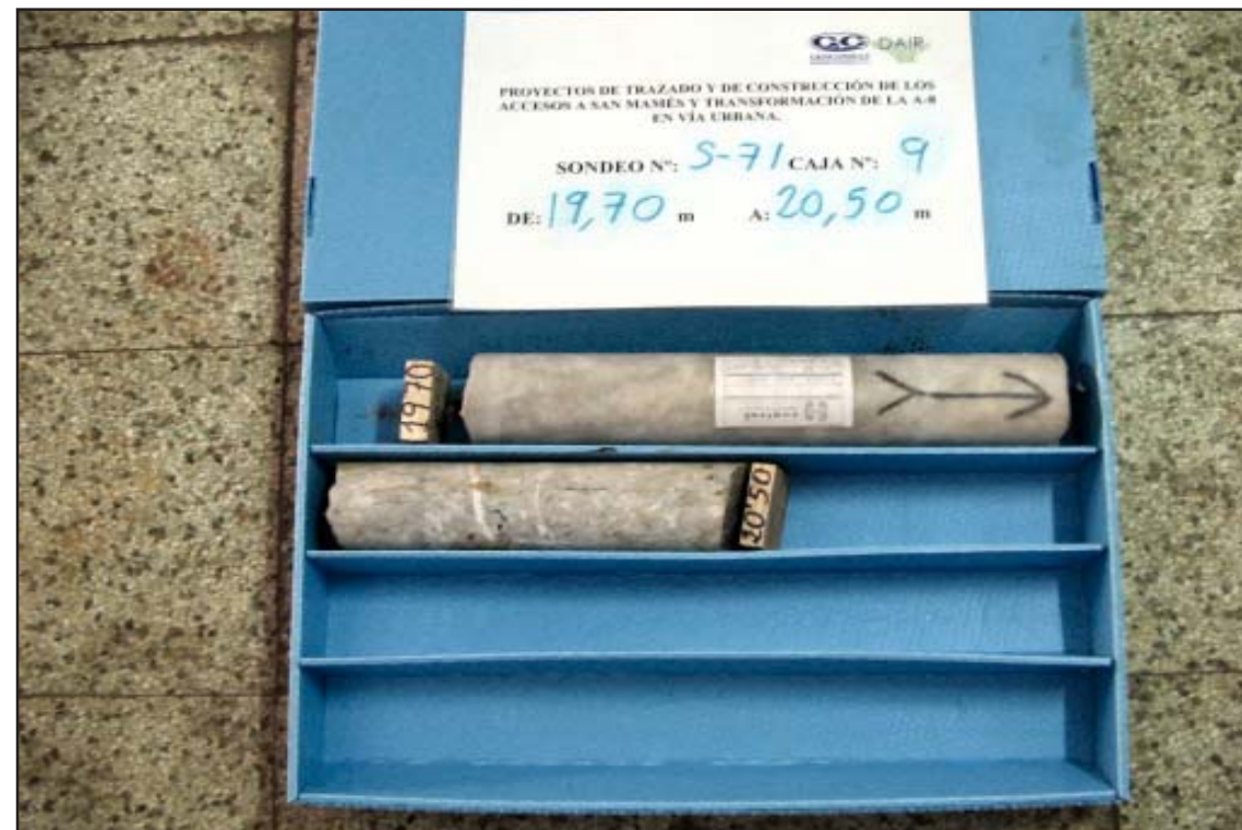
CAJA-09. Profundidad de 19.70 m a 20.50 m (Fín de Sondeo)
