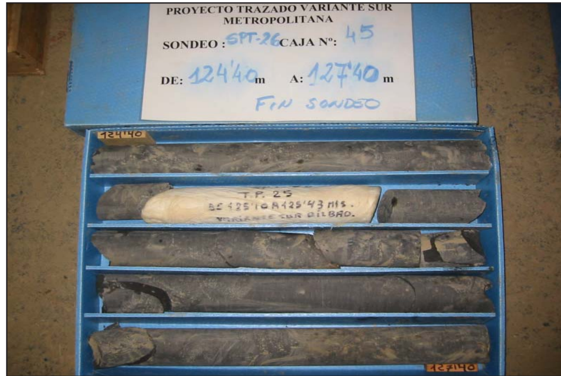
CAJA-45. Profundidad de 124.40 m a 127.40 m (Fín de Sondeo)
