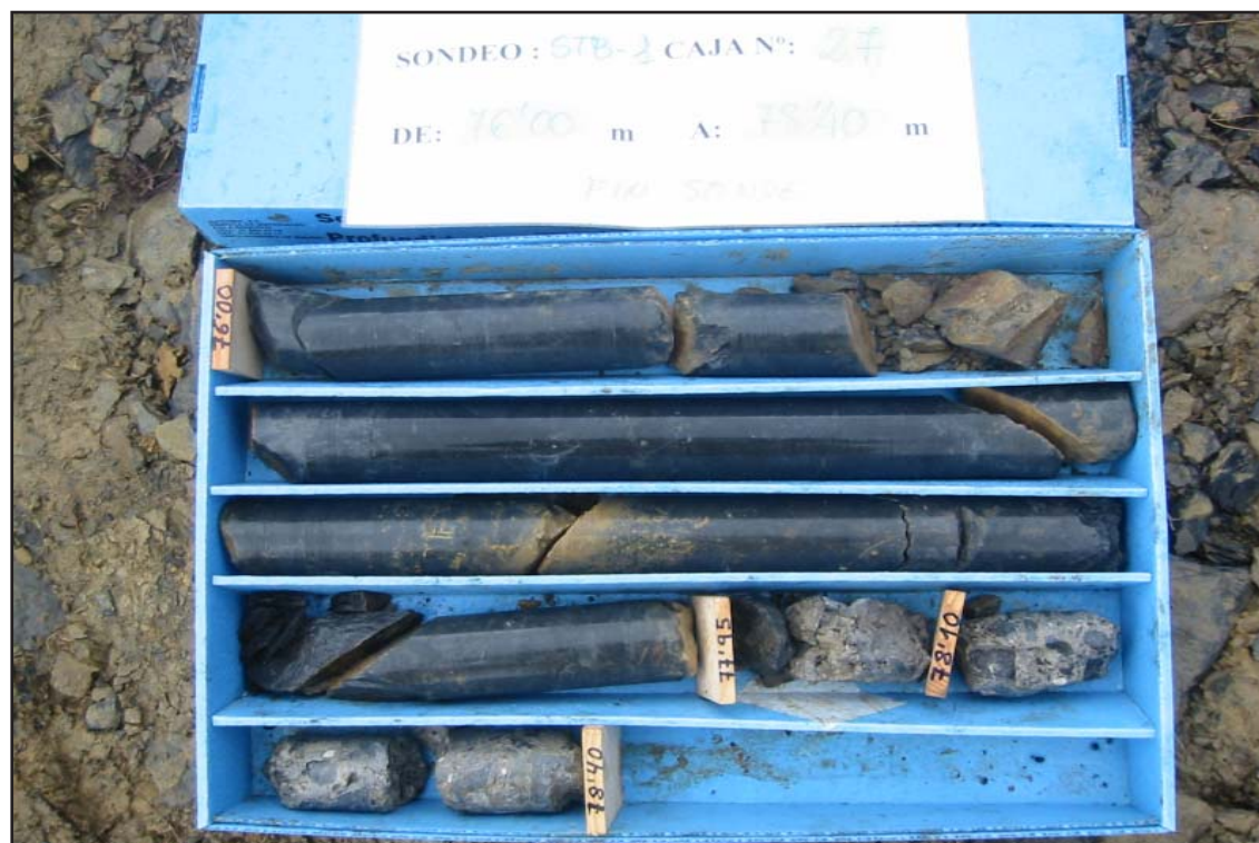
CAJA-27. Profundidad de 76.00 m a 78.40 m (Fín de Sondeo)
