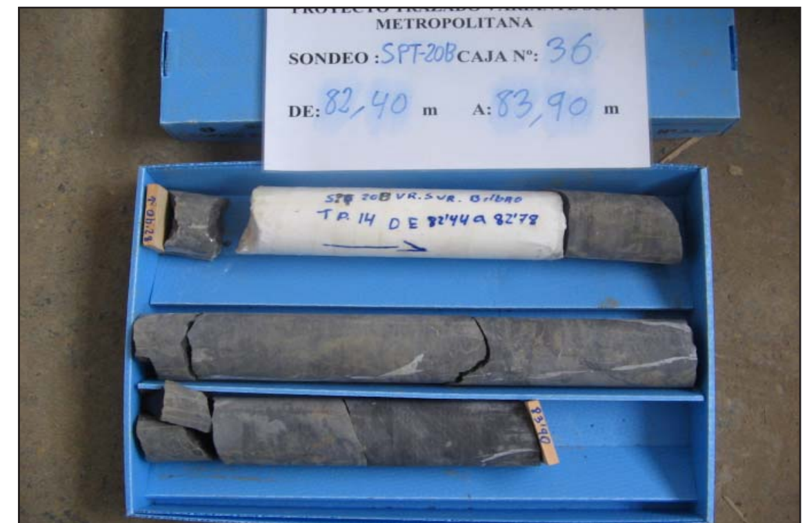
CAJA-36. Profundidad de 82.40 m a 83.90 m (Fín de Sondeo)
