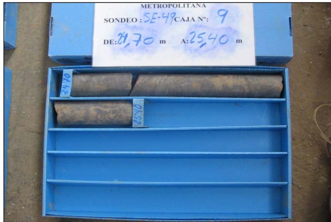
CAJA-09. Profundidad de 24.70 m a 25.40 m (Fín de Sondeo)
