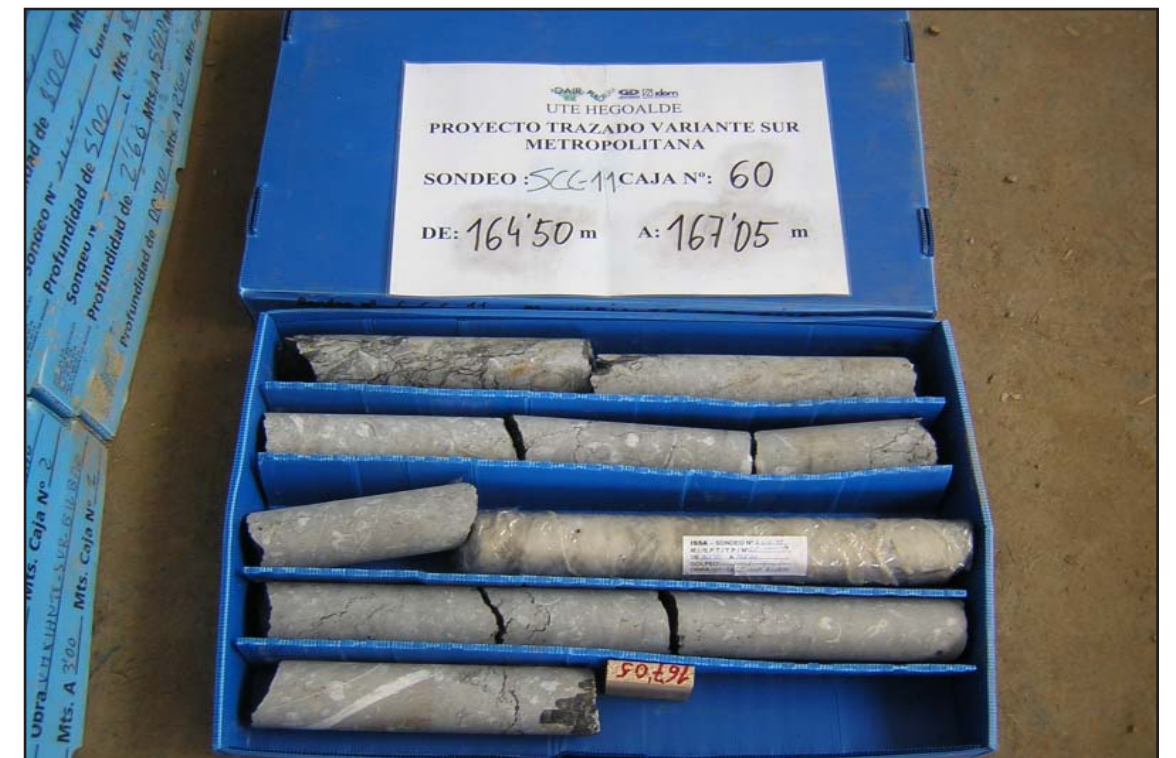
CAJA-60. Profundidad de 164.50 m a 167.05 m (Fín de Sondeo)
