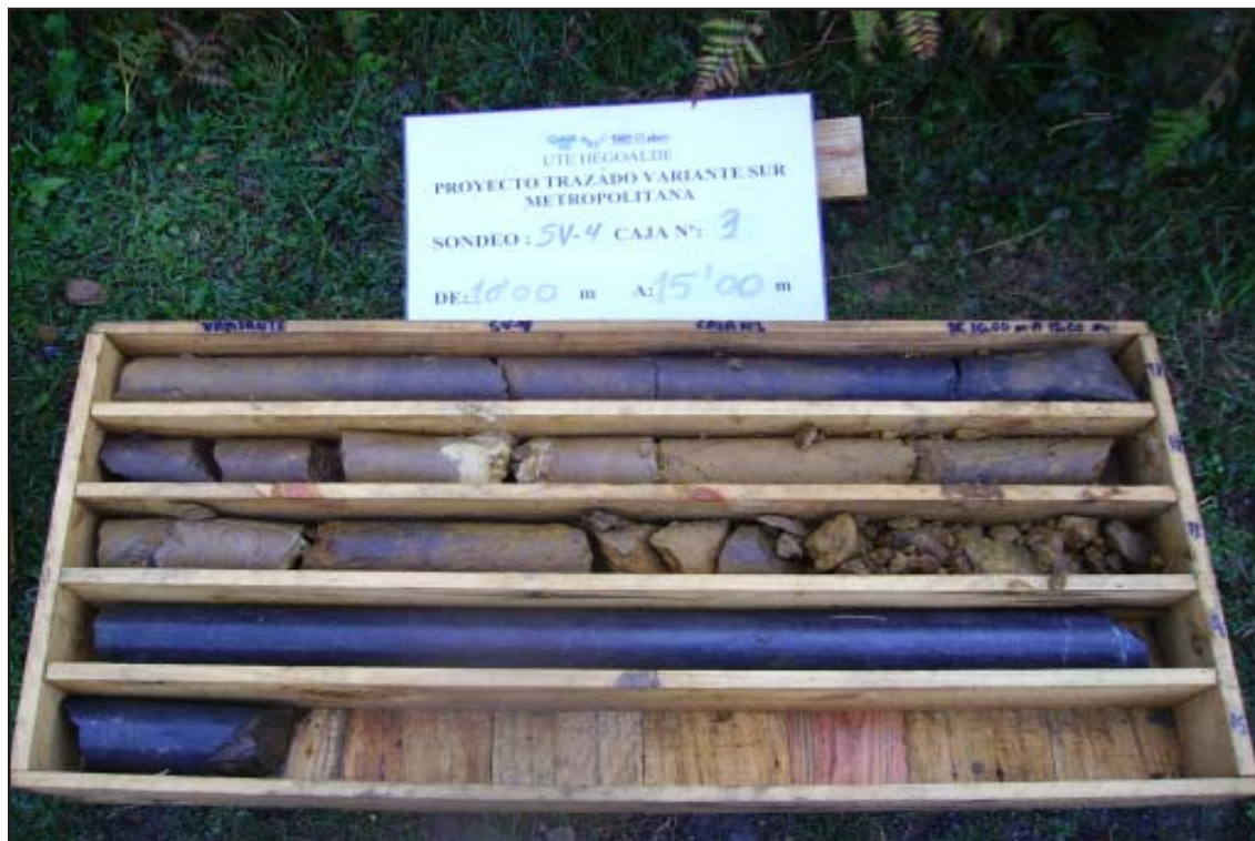
CAJA-03. Profundidad de 10.00 m a 15.15 m (Fín de Sondeo)
