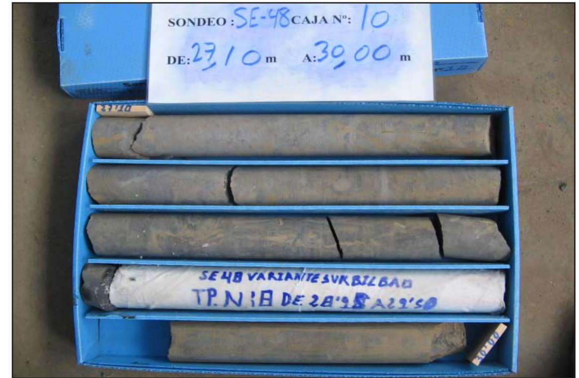
CAJA-10. Profundidad de 27.10 m a 30.00 m (Fín de Sondeo)
