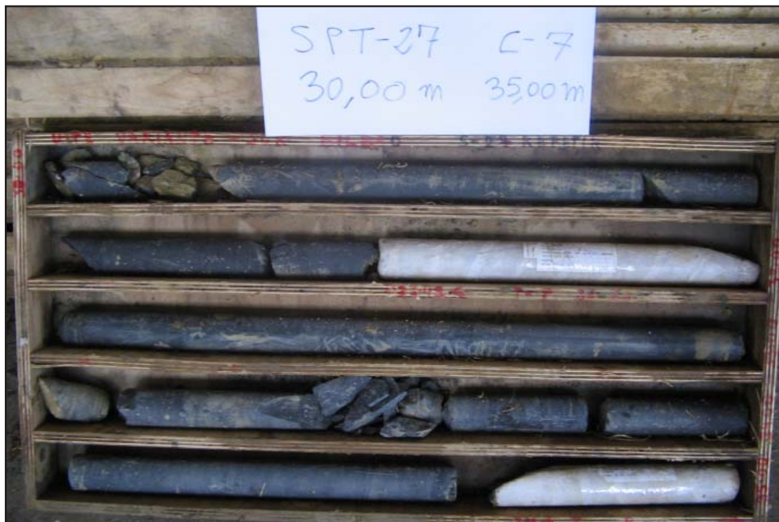
CAJA-07. Profundidad de 30.00 m a 35.00 m (Fín de Sondeo)
