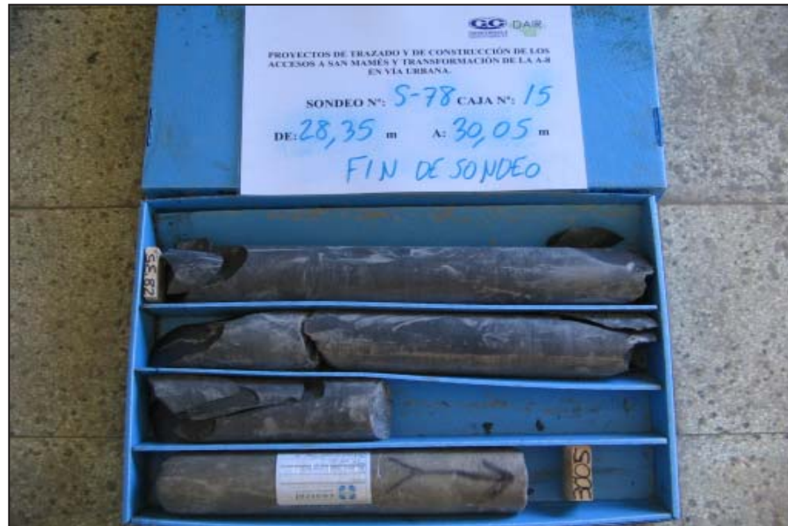
CAJA-15. Profundidad de 28.35 m a 30.05 m (Fín de Sondeo)
