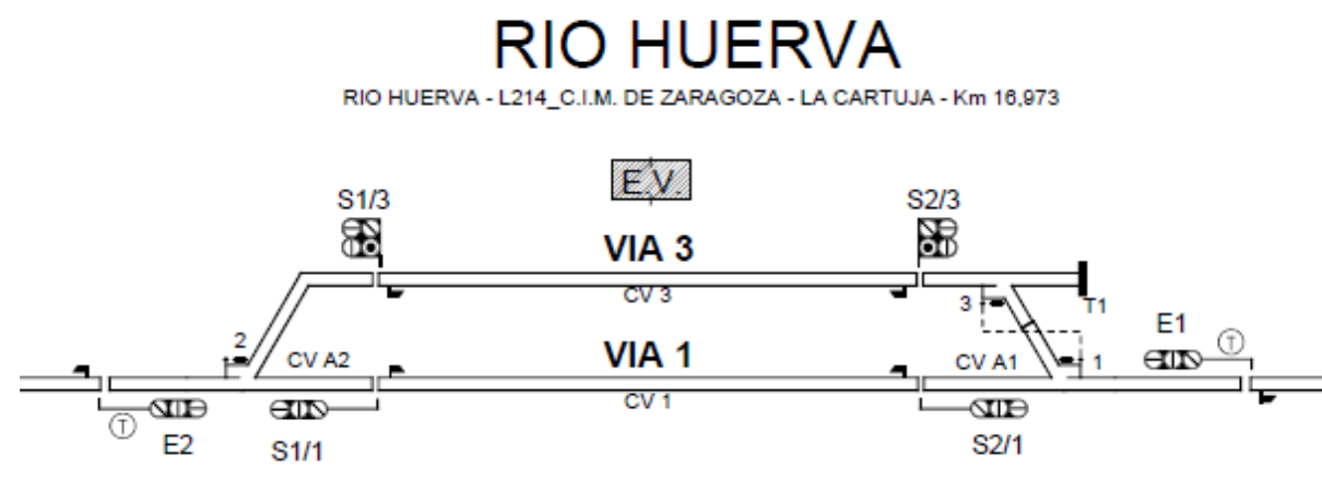
Figura 8–9. Apeadero del río Huerva. Esquema actual de vías
