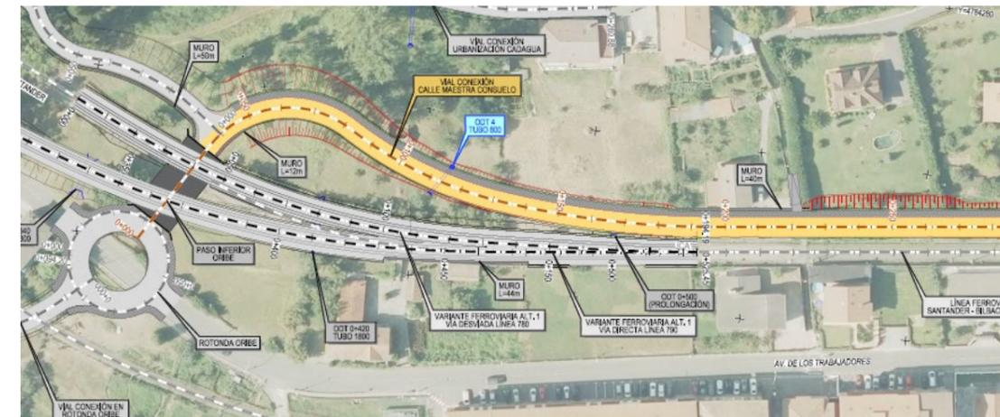
Tiene una sección transversal de 8 metros, con calzada de 6 metros (dos carriles de 3,00 metros) y una acera lateral de dos metros. En algunos tramos se dispone de un muro para disminuir la ocupación del terraplén y el impacto visual de la actuación, quedando integrado en el mismo corredor que la línea ferroviaria 780 Santander – Bilbao La Concordia.
