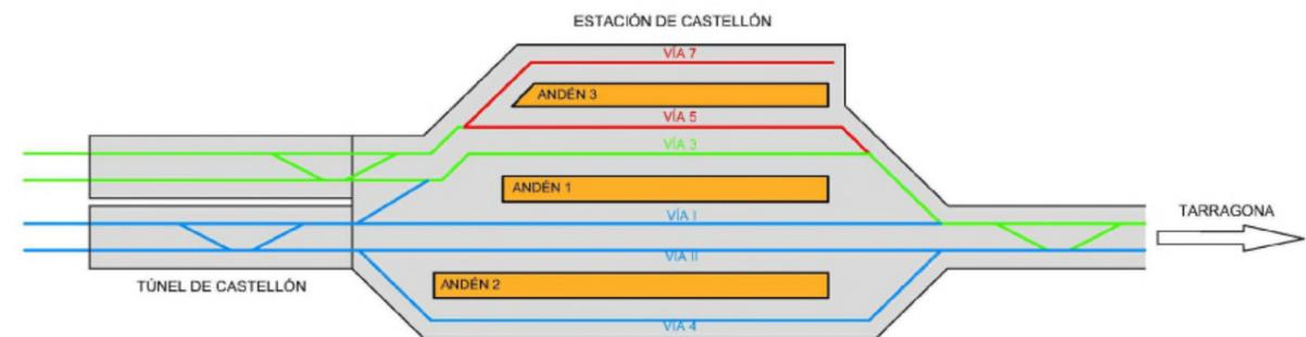
Imagen. Esquema propuesto para la estación de Castellón.
