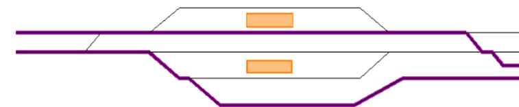
La propuesta de configuración funcional de la Alternativa 2 se considera óptima, no sólo por ser compatible a futuro con la planificación a largo plazo, sino por la flexibilidad en la explotación de los servicios de cercanías que aportan las dos vías de apartado y el ramal de acceso a la terminal de Vicálvaro.
