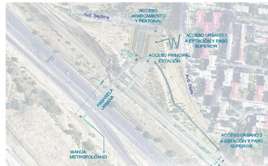
La conexión de la estación con el entorno urbano se produciría mediante un vial hasta la avenida Séptima que a su vez desemboca con el final de la calle Alcalá. Por su parte, el acceso desde la avenida Sexta se produciría por un vial existente que salva la diferencia de costas mediante un zigzag en rampa o bien desde un paso existente en la zona sur de dicha avenida.
