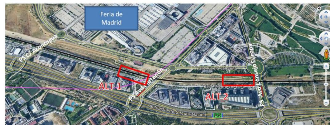
En este ámbito se prevé la futura cuadruplicación de la línea de contorno mediante la ampliación de la plataforma con dos vías adicionales por la margen noroeste donde las vías interiores sean vías con tráfico predominante de mercancías y las exteriores de viajeros.
