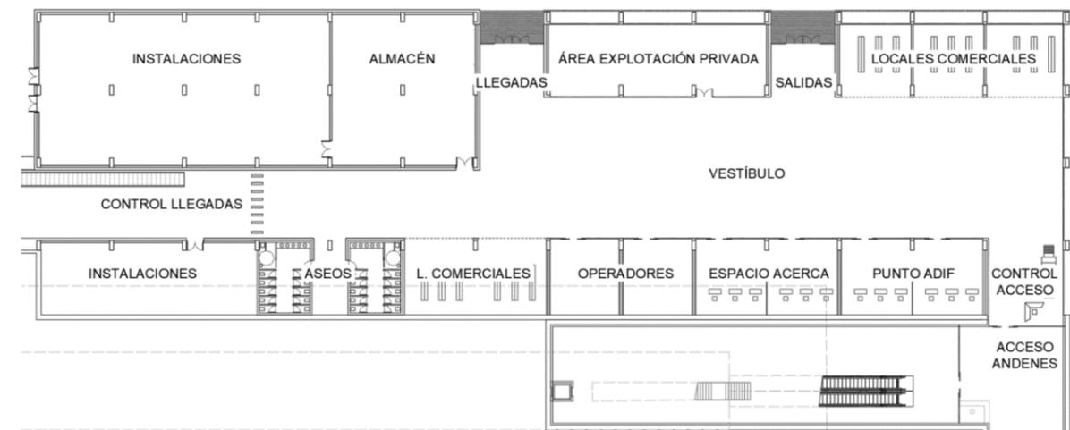
En la esquina noreste del edificio, se localiza el control de acceso para los pasajeros antes del embarque que, a través de un paso bajo la plataforma ferroviaria, llegan a la zona de embarque de los diferentes andenes para poder acceder a los mismo a través de elementos de comunicación vertical. Estos elementos incluyen ascensor, escaleras mecánicas y escaleras fija.
