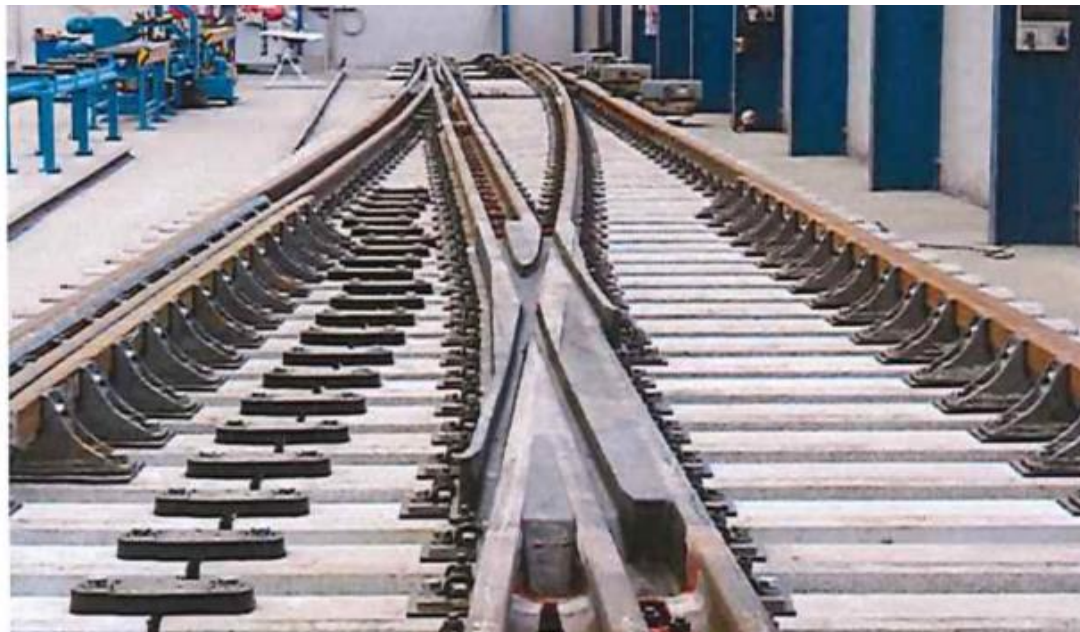
Figura 8. Ejemplo de desvío de 3 hilos Mixto-Mixto.
