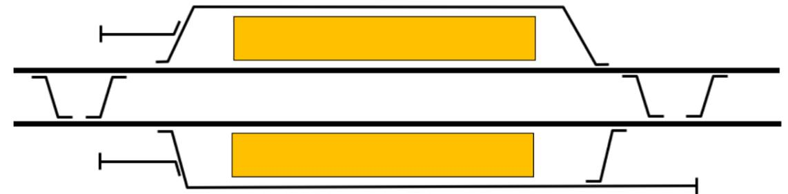
**Figura 3. Esquema de estación con vías generales con acceso a andén**
