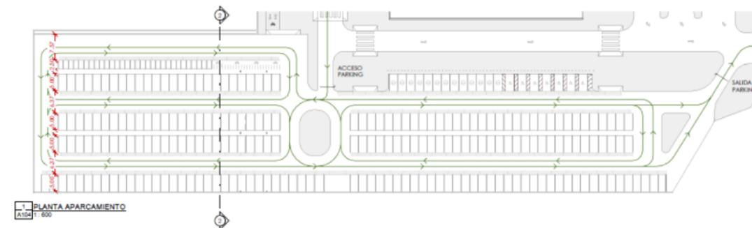
**Figura 19. Planta general del nuevo estacionamiento con el esquema de circulaciones. Propuesta para Nueva estación de AV para Pamplona.**
