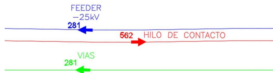
Fig.1 Alzado de un tramo de la catenaria con el reparto de intensidades(A).
