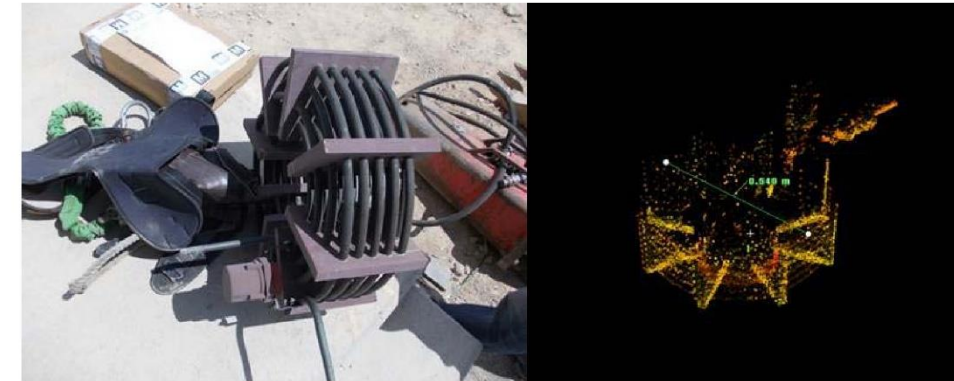
Figura 16. Fotografía de una bobina de bloqueo similar a la instalada y escaneado 3D de la bobina de la subestación Utebo, línea La Joyosa.
