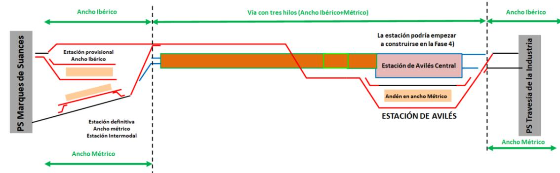
Durante esta séptima fase provisional se procede a la ejecución del interior del soterramiento del tramo urbano, destacando entre otras, las labores de excavación, ejecución de losas inferiores, superestructura e instalaciones de electrificación y comunicaciones.
