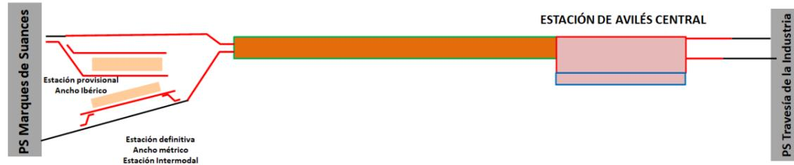
Una vez levantado el desvío provisional y puesto en servicio el corredor ferroviario soterrado se procede a la ejecución final de las vías que quedaban por ejecutar dentro de la futura estación de Avilés Central, en concreto a la vía exterior en ancho métrico.
