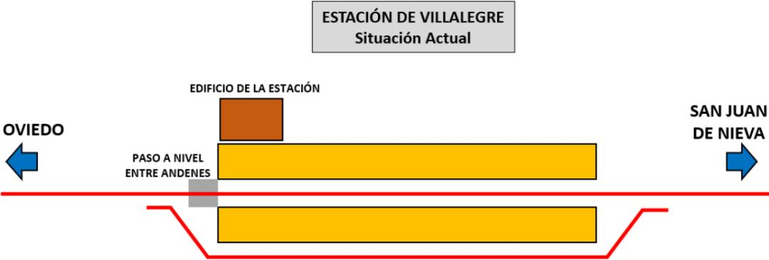
La configuración prevista dispone las dos vías generales juntas, por lo que el andén central actual debe ser demolido y construirse un nuevo andén adosado a la nueva vía general, que tendría continuidad en el futuro para conformar la doble vía.
