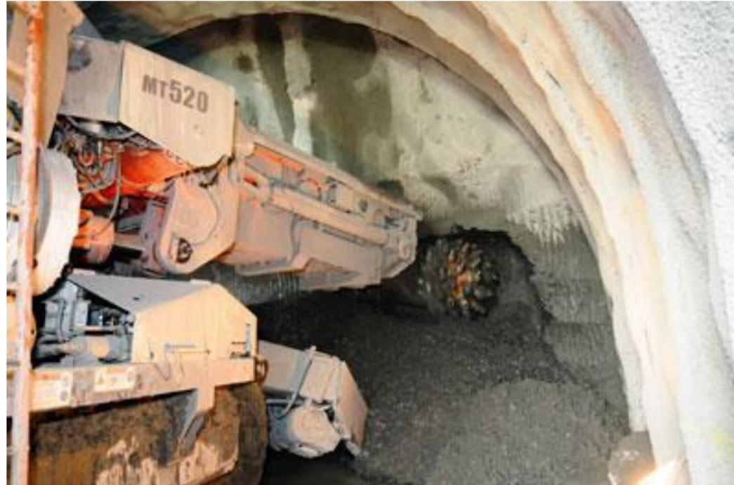
**Ilustración 19: Máquina rozadora para túneles (excavación mecánica)**
